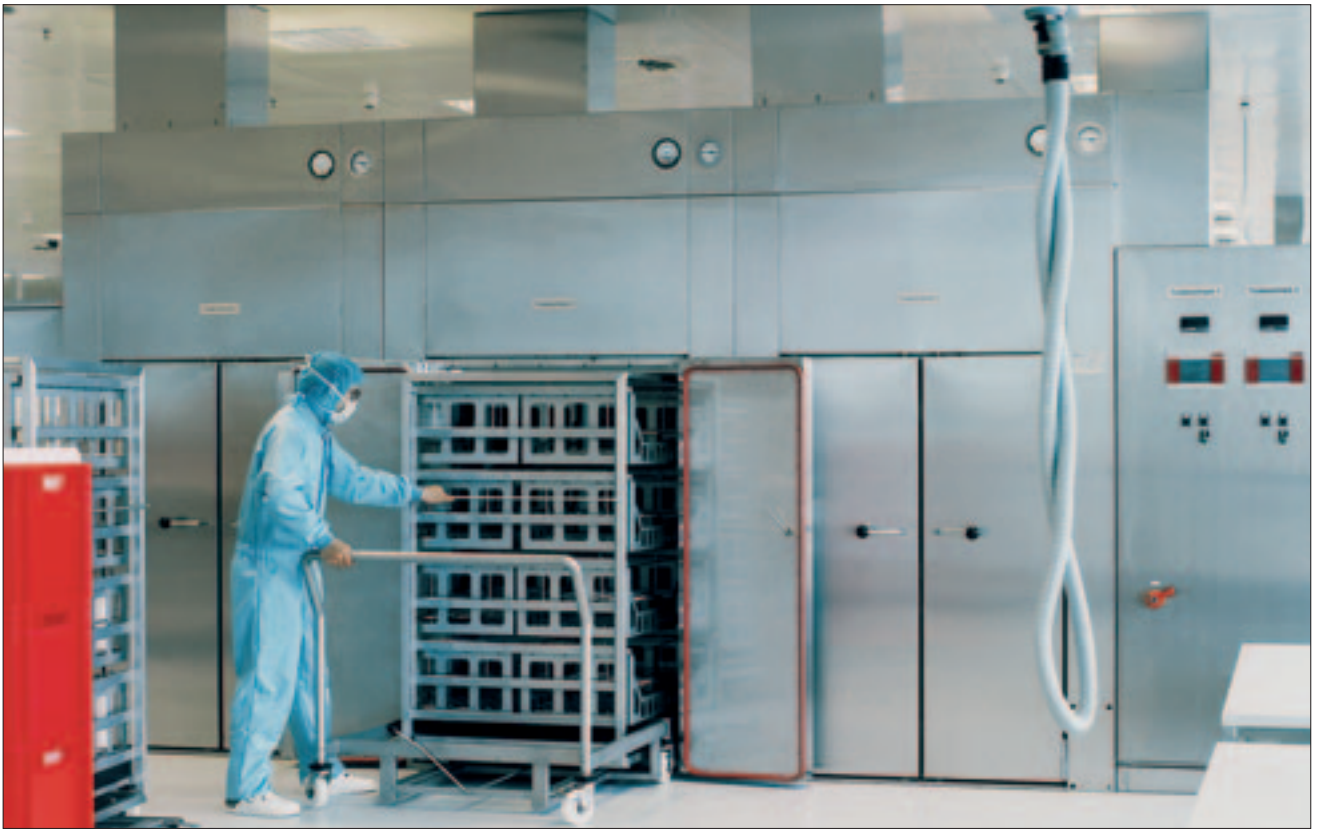
Dry heat steriliser VHS 100/150 GMP
