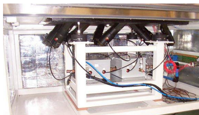
Prüftisch mit pneumatischen Zylindern
